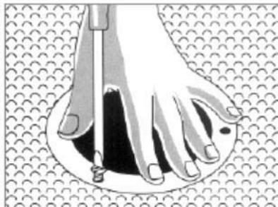
Figure 10 – Raccordement du revêtement au siphon
